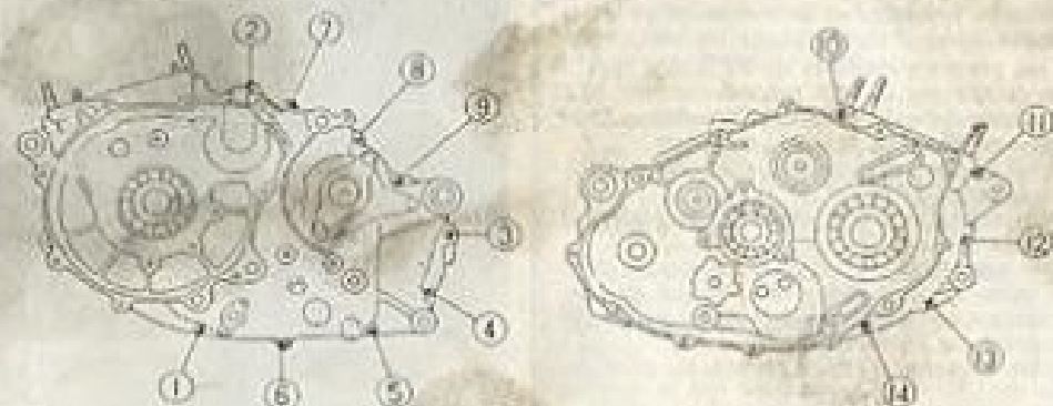
Positionnement et ordre de serrage des vis d'assemblage des demi-carter moteur.
