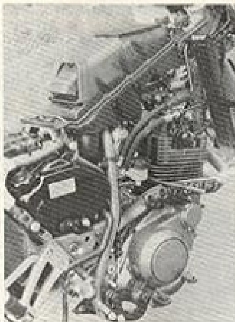
Le boîtier de filtre à air est logé sous le réservoir à essence (Photo RMT).
