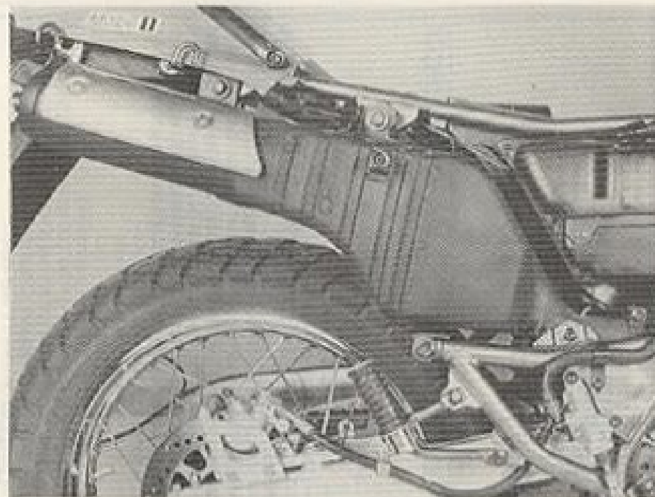
L'échappement fait partie intégrante du cadre (Photo RMT).
