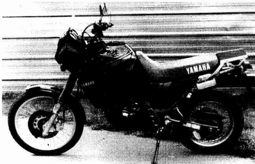
La Yamaha XTZ 660 Ténéré modèle 1992 reste techniquement identique au premier modèle 91 à l'exception de la décoration des flancs du réservoir à essence et des caches latéraux (Photo ETAI).
