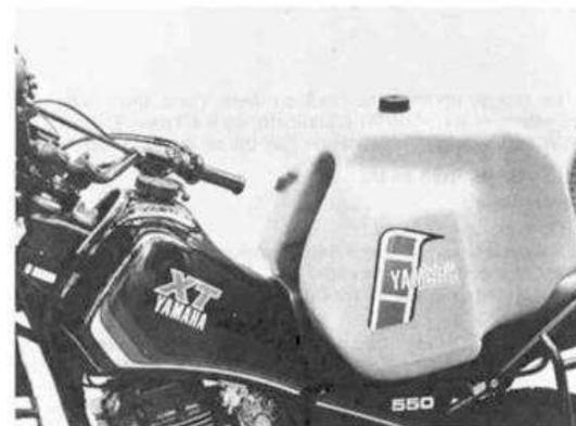
Réservoir à essence de 39 litres DS Products qui peut s'adapter sur de nombreux modèles grâce à des jeux de fixation (Photo RMT)
