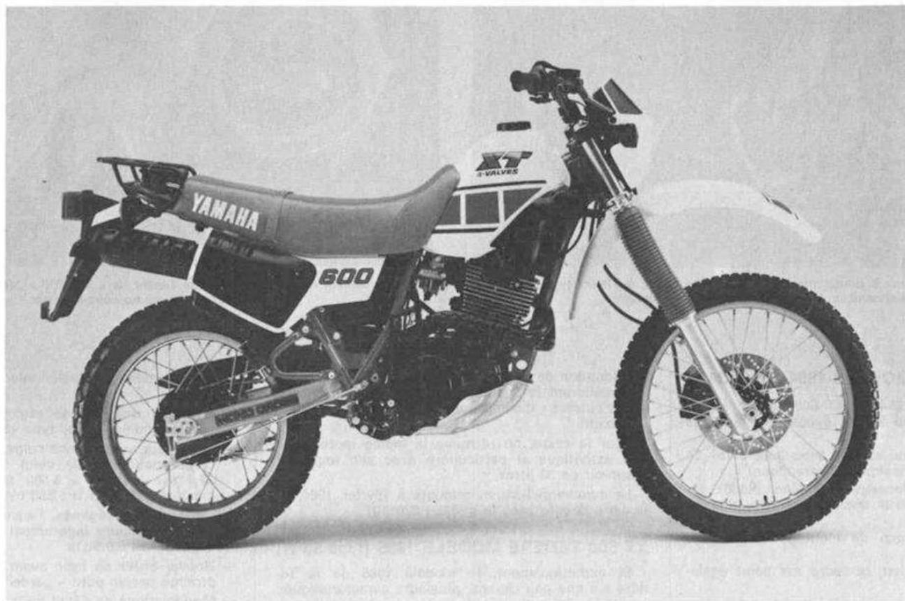
*Yamaha « XT 600 » : Ténéré par le moteur et les suspensions, « TT 600 » par l'esthétique*
