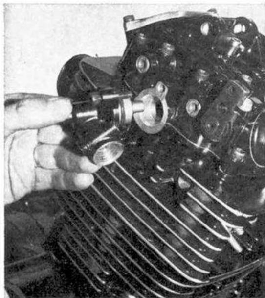
PHOTO 57 : Enlever la prise de compte-tours avant de déposer le couvercle de culasse (Photo RMT)
