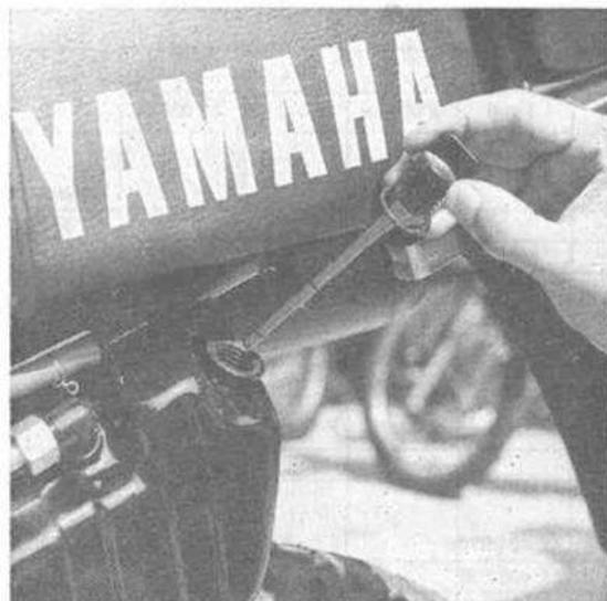
PHOTO 3 : Niveau d'huile dans le réservoir de la XT 600 (Photo RMT)
