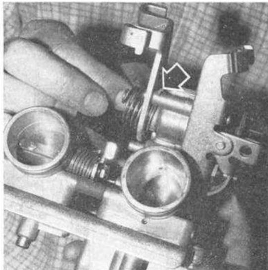
**PHOTO 41 :** Ancrage du ressort de rappel sur le carburateur (Photo RMT)
