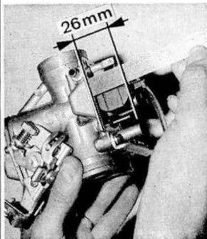
PHOTO 38 : Contrôle de la hauteur de flotteur (Photo RMT)
