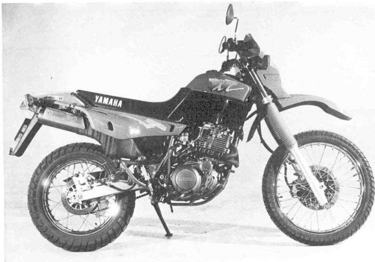
*La XT 600 K apparue en 1991 n'est autre que la XT 600 E de 1990 sur laquelle le démarreur électrique a été remplacé par un kick-starter (Photo RMT)*
