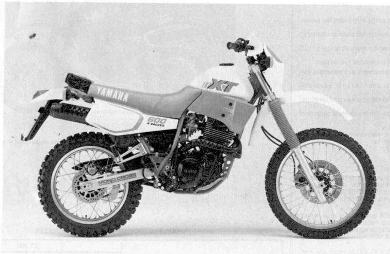
Yamaha XT 600 modèle 1987 avec ses larges écopes de refroidissement du moteur et son frein arrière à disque
