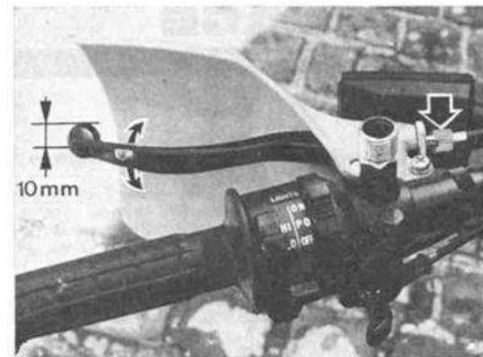
PHOTO 19 : Garde à l'embrayage réglable à l'aide du tendeur (Photo RMT)
