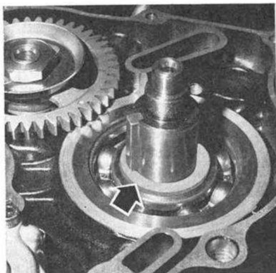
PHOTO 49 : Ne pas oublier cette rondelle sous la clavette des pignons du vilebrequin (Photo RMT)
