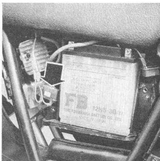
PHOTO 21 : Batterie et disjoncteur des XT 400/550 visibles après dépose du cache latéral droit (Photo RMT)
